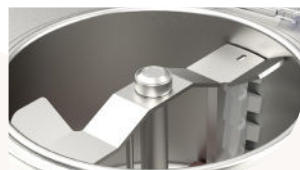
Cuve ouverte et bras de mélange
